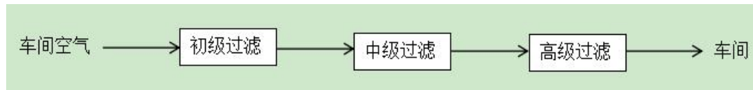
图 2-2 十万级空气净化系统处理工艺
