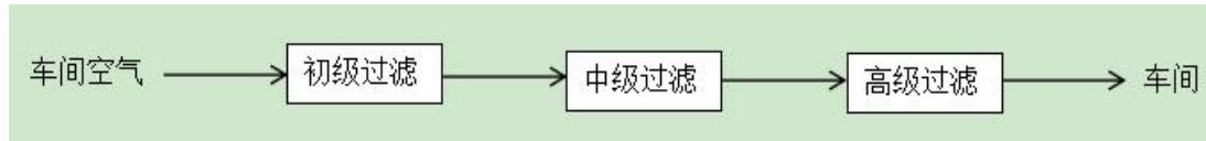
图 2-2 十万级空气净化系统处理工艺
