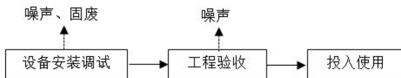
图 2-2 施工期工艺流程及产污环节图
